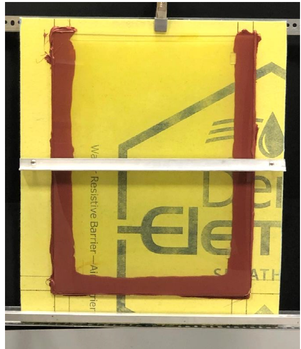
Fig. 2. Face column test apparatus.
